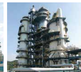
残油流動接触分解装置 原料である重油を高温低圧雰囲気中で触媒と接触させることで分解し、プロピレン・LPG・ガソリン留分を製造します。
